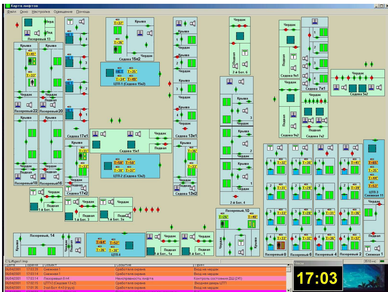
Рисунок 6 - Пример отображаемой информации на карте лифтов
